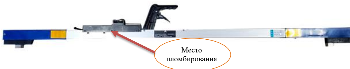
Рисунок 4 – Места пломбирования шаблонов ШП (указаны стрелкой).
