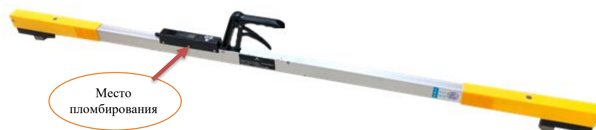
Рисунок 3 – Места пломбирования шаблонов ШПЭ (указаны стрелкой)
