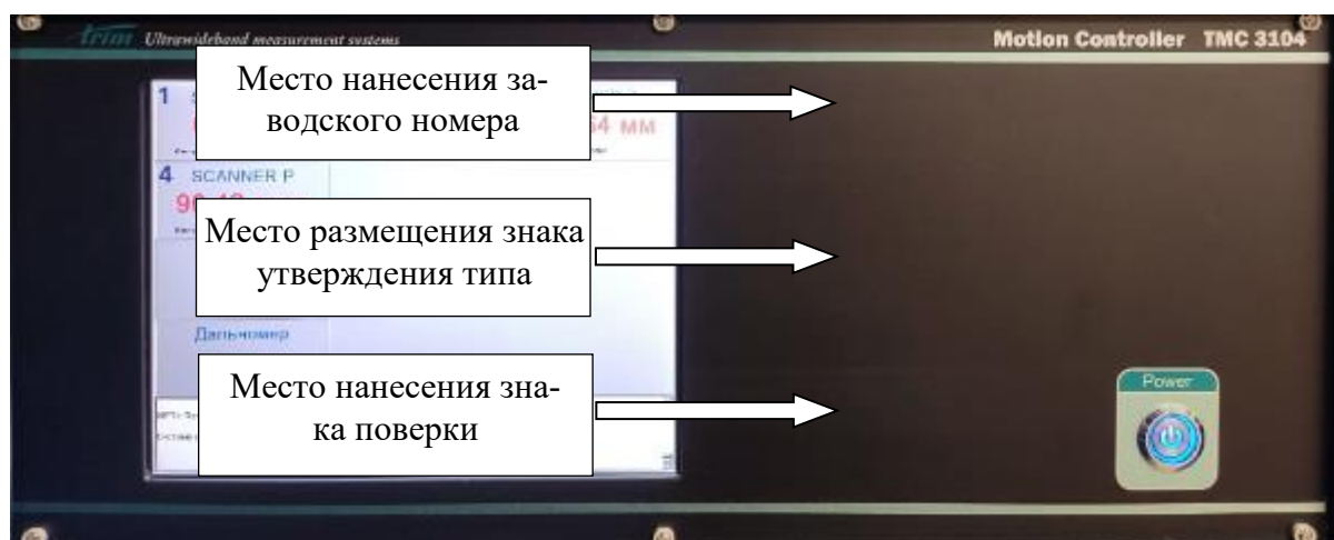
Рисунок 7 – Общий вид контроллера управления сканера с указанием места размещения знака утверждения типа, знака поверки, заводского номера
