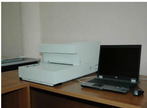
Рисунок 1 – Общий вид комплексов для измерений линейных размеров дефектов на радиографических снимках модификации ОЦИФРОВЩИК А
