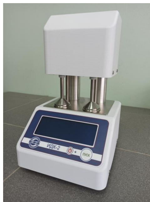
а) б) Рисунок 1 – Общий вид измерителей деформации клейковины ИДК-М а) модификация ИДК-1, б) модификация ИДК-2
