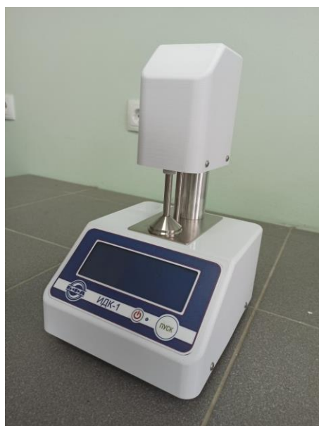
а) б) Рисунок 1 – Общий вид измерителей деформации клейковины ИДК-М а) модификация ИДК-1, б) модификация ИДК-2
