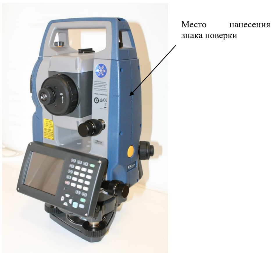
Рисунок 1 – Общий вид тахеометров электронных SOKKIA FX
