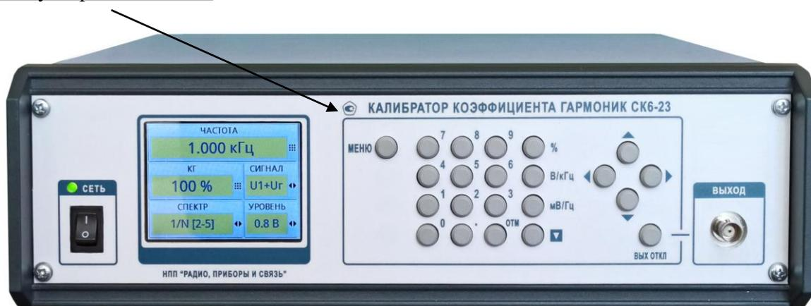
Рисунок 1 – Общий вид калибратора
