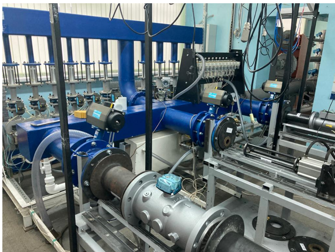
Рисунок 3 – Исполнение на соплах установки поверочной промышленной «Стандарт»
