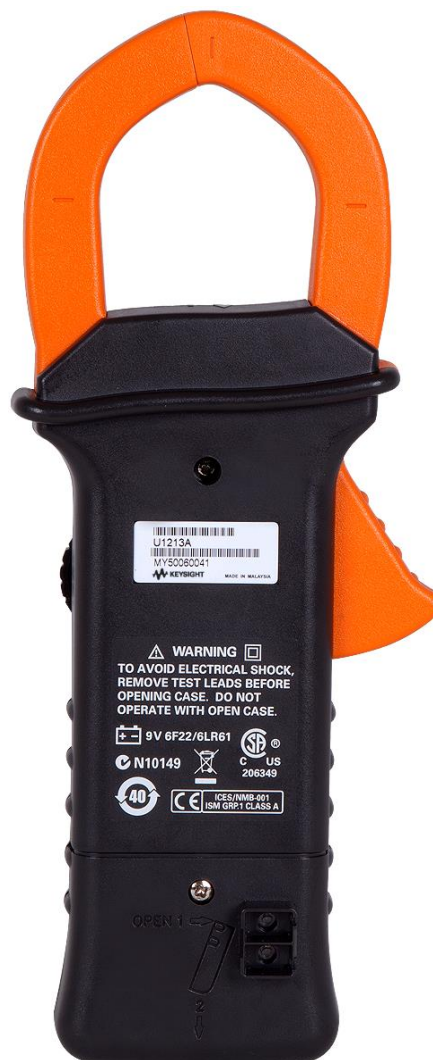
Рисунок 4 – Общий вид клещей электроизмерительных U1213A. Вид сзади
