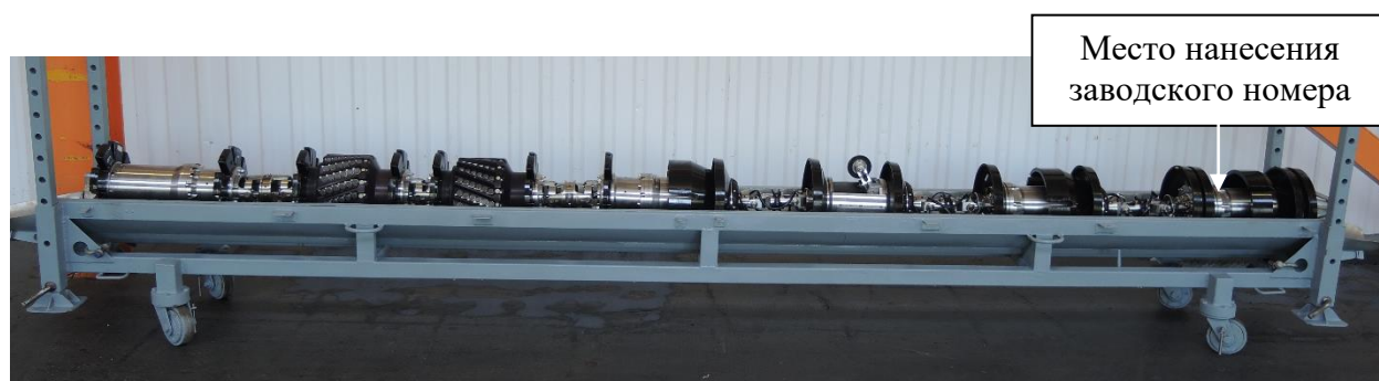
Рисунок 2 – Общий вид дефектоскопа внутритрубного ультразвукового 10-УСК.04-00.000 (в варианте использования с типом диагностики CD)
