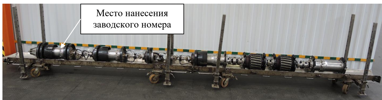
Рисунок 1 – Общий вид дефектоскопа внутритрубного ультразвукового 10-УСК.04-00.000 (в варианте использования с типом диагностики WM)
