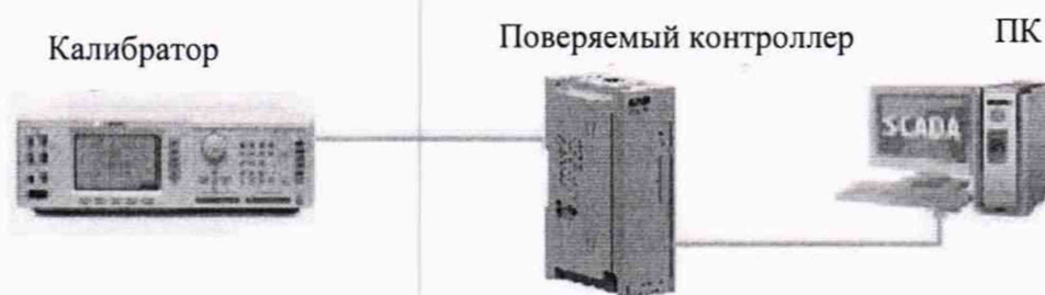
Рисунок 4 – Схема подключения при определении приведенной (к диапазону измерений) основной погрешности измерений сигналов от датчиков с унифицированным сигналом силы постоянного тока и напряжения постоянного тока
