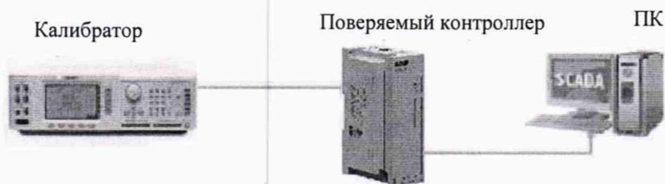
Рисунок 5 – Схема подключения при определении приведенной (к диапазону измерений) основной погрешности измерений входных сигналов от датчиков с сигналами напряжения постоянного тока
