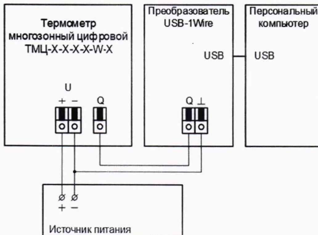
Рисунок А.2 – Схема соединений для проверки абсолютной погрешности измерений температуры и передачи измеренных значений по интерфейсу для модификации ТМЦ-X-X-X-X-W-X
