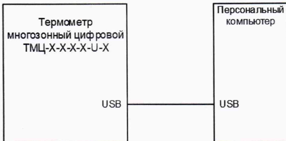
Рисунок А.3 – Схема соединений для проверки абсолютной погрешности измерений температуры и передачи измеренных значений по интерфейсу для модификации ТМЦ-X-X-X-X-U-X
