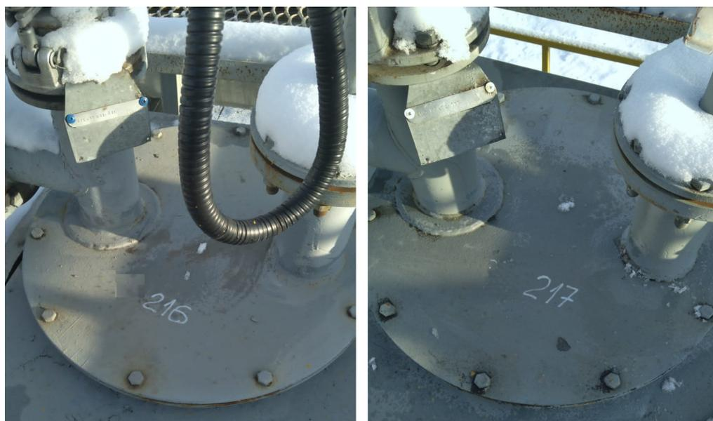
Рисунок 1 – Место нанесения заводских номеров
