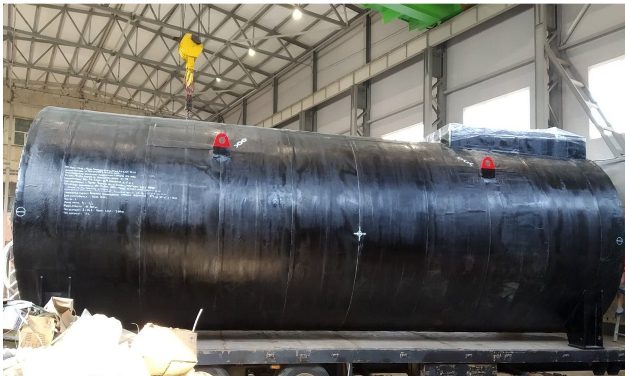
Рисунок 1 – Общий вид резервуаров РГСпД
