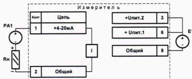
Рисунок 3 – Схема подключения устройства при определении приведённой погрешности воспроизведения силы постоянного тока. Измеритель – поверяемое устройство.
