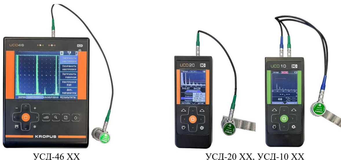
Рисунок 1 – Общий вид дефектоскопов ультразвуковых серии УСД
