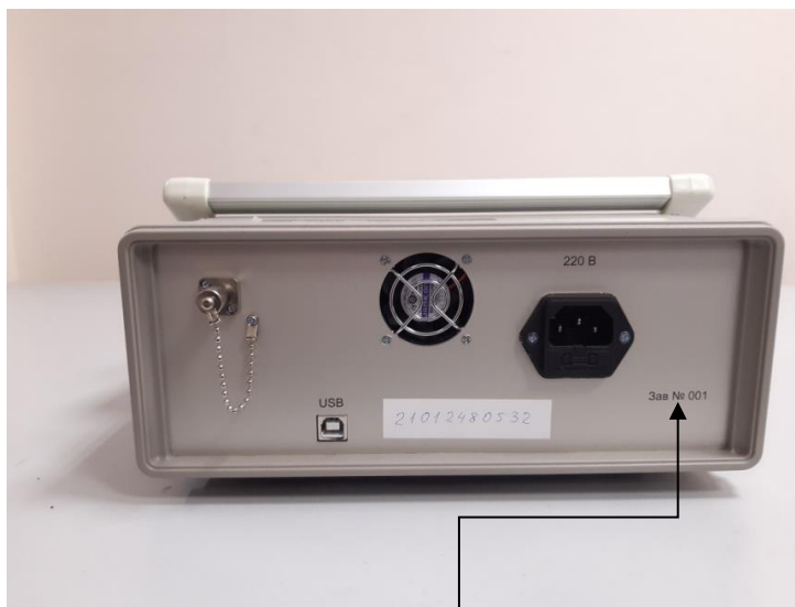
Рисунок 1 – Общий вид эталона, схема пломбировки от несанкционированного доступа, обозначения места нанесения знака поверки
