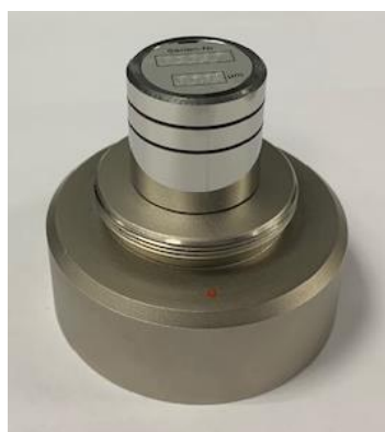
Рисунок 2 – Мера для калибровки увеличения к прибору FMS 8200
