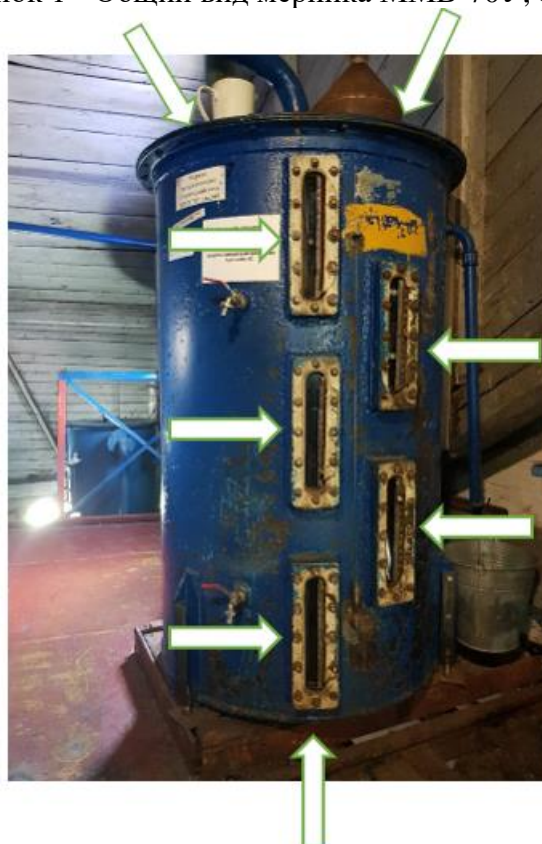
Рисунок 2 – Схема пломбировки мерника ММВ-70У, зав.№ 5 от несанкционированного доступа, обозначение места нанесения знака поверки
