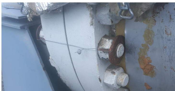
Рисунок 3 – Схема пломбировки фланцевых соединений
