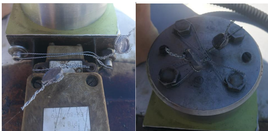
Рисунок 2 – Схема пломбировки детекторов
