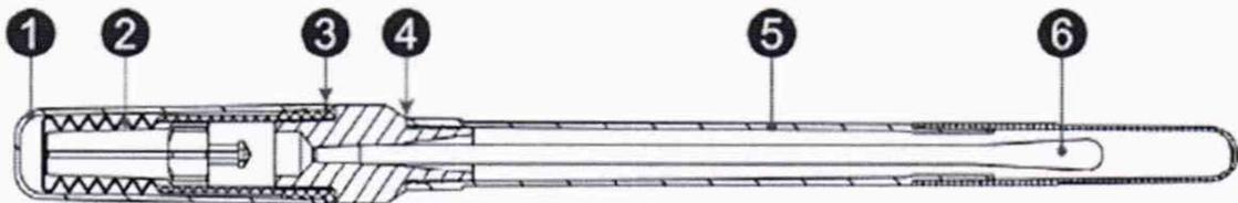
1 – колпачок, 2 – колпачок пружины (внутренний), 3 – активируемый клапан, 4 – место для надлома клапана, 5 – пробирка для теста, 6 – ватная палочка
