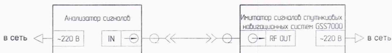
Рисунок 2 — Схема измерений для определения погрешности установки уровня мощности выходных сигналов
