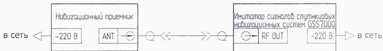
Рисунок 1 — Схема подключения имитатора сигналов для проверки работоспособности
