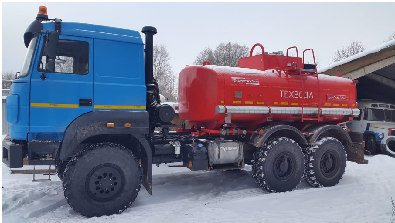
Рисунок 1- Общий вид автоцистерны нефтепромысловой УСТ 545307
