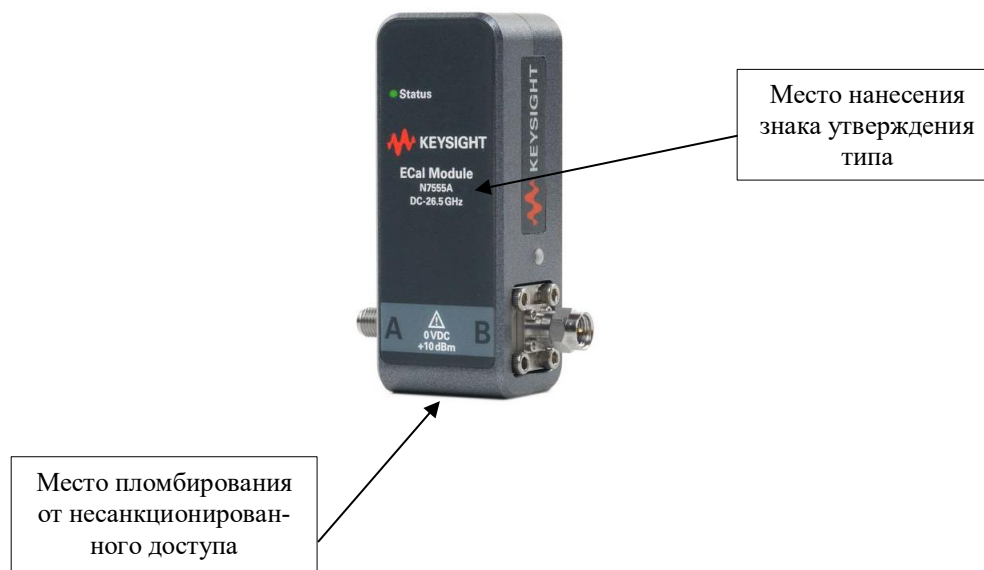
Рисунок 3 - Общий вид наборов мер коэффициентов передачи и отражения электронных модификаций N7550A, N7551A, N7552A, N7553A, N7554A, N7555A
