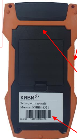
Рисунок 11 – Место нанесения заводского номера, место пломбировки от несанкционированного доступа, место наклейки знака утверждения типа источников оптического излучения КИВИ-422У, КИВИ-423У, измерителей оптической мощности КИВИ-432У, КИВИ-433У, тестеров оптических КИВИ-445У-0Z
