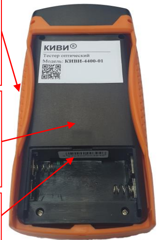
Рисунок 12 – Место нанесения заводского номера, место пломбировки от несанкционированного доступа, место наклейки знака утверждения типа тестеров оптических КИВИ-440У-0Z
