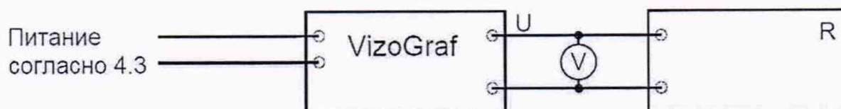
Рисунок Б.7 – Схема подключения приборов комплексов с диапазоном воспроизведения выходных сигналов постоянного тока с питанием каналов воспроизведения от внешнего источника напряжения
