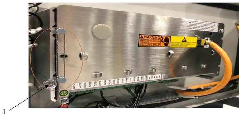
Рисунок 2 – Схема пломбировки от несанкционированного доступа, обозначение места нанесения знака поверки (1 – свинцовая или пластиковая пломба со знаком поверки в виде оттиска поверительного клейма)
