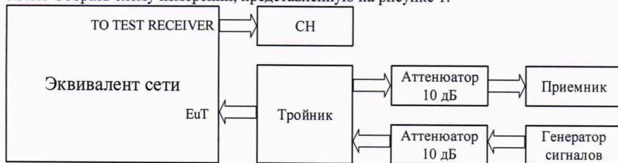
Рисунок 1 - Схема калибровки выходного уровня генератора сигналов
