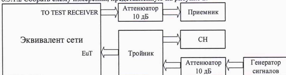
Рисунок 2 - Схема измерений выходного уровня эквивалента сети
