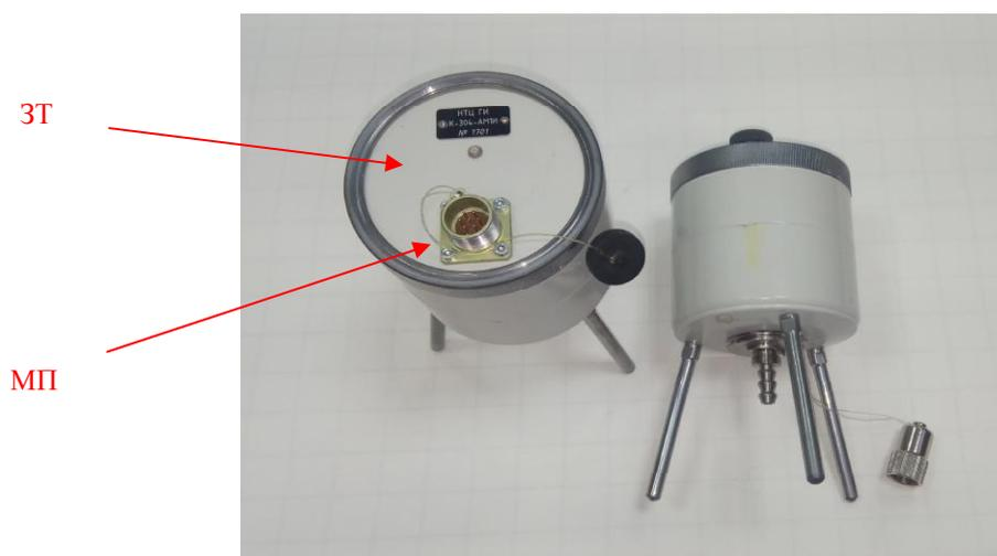
Рисунок 1 – Общий вид микробарометра
