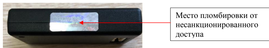
Рисунок 2 - Место пломбировки от несанкционированного доступа
