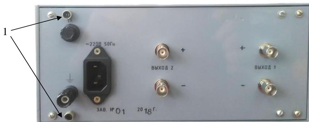
1 - место пломбировки с оттиском поверительного клейма.
