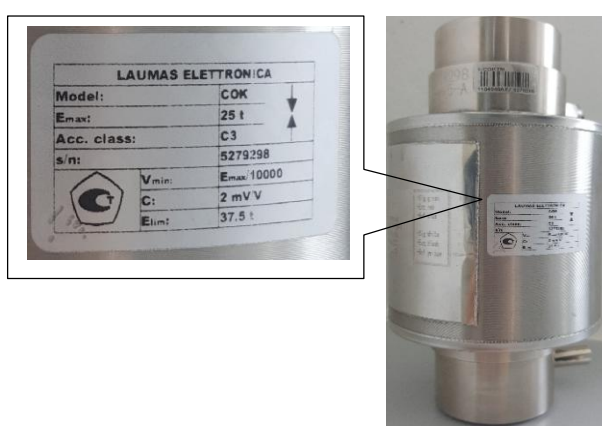
Рисунок 2 – Пример маркировочной таблички датчиков
