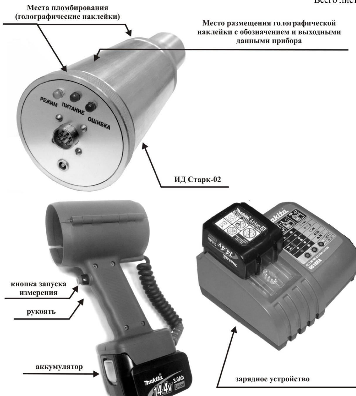
Рисунок 1 - Общий вид УСГМ и схема пломбировки от несанкционированного доступа
