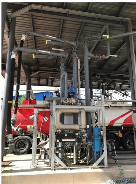
Рисунок 1 – Общий вид комплекса наливного измерительного E3000
