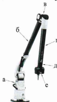
Рисунок 4 – Схема расположения сегментов машины а – основание; б – плечо; в – локоть; г – предплечье; д – запястье; е – кисть
