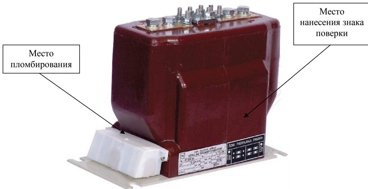
Рисунок 1 - Общий вид трансформаторов тока STEM-N с указанием мест пломбирования от несанкционированного доступа и нанесения знака поверки
