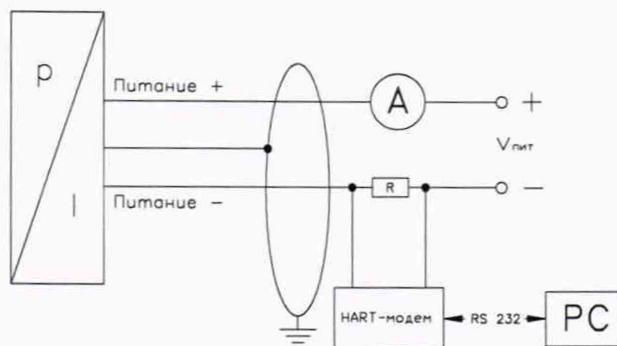
3-х пров. (вых. сигнал - напряжение)
