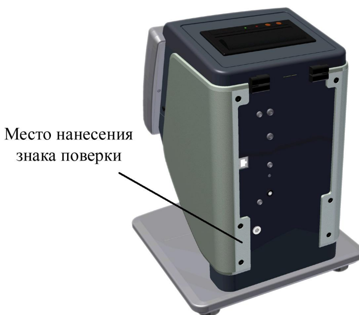
Рисунок 2 - Обозначение места нанесения знака поверки
