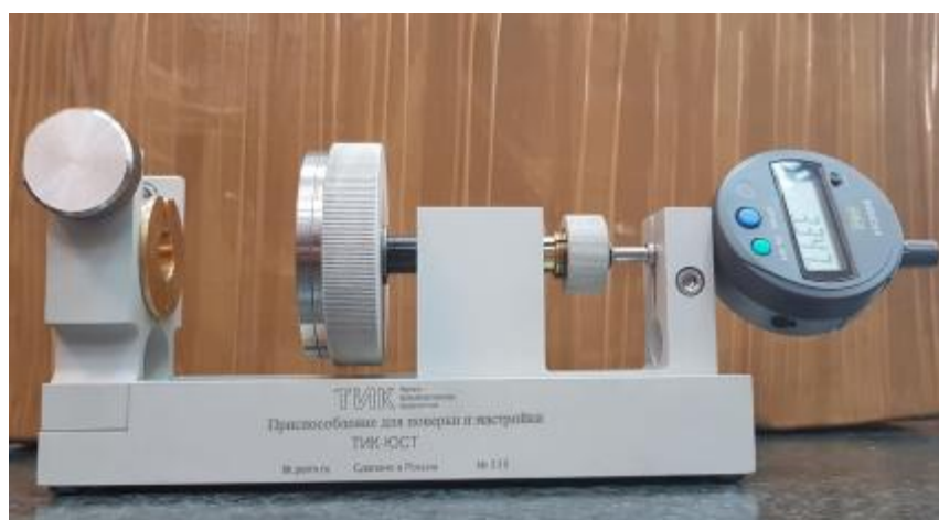
Рисунок 3- Общий вид устройства для поверки и настройки вихретовых преобразователей ТИК-ЮСТ с головкой измерительной цифровой ABSOLUTE серии 543
