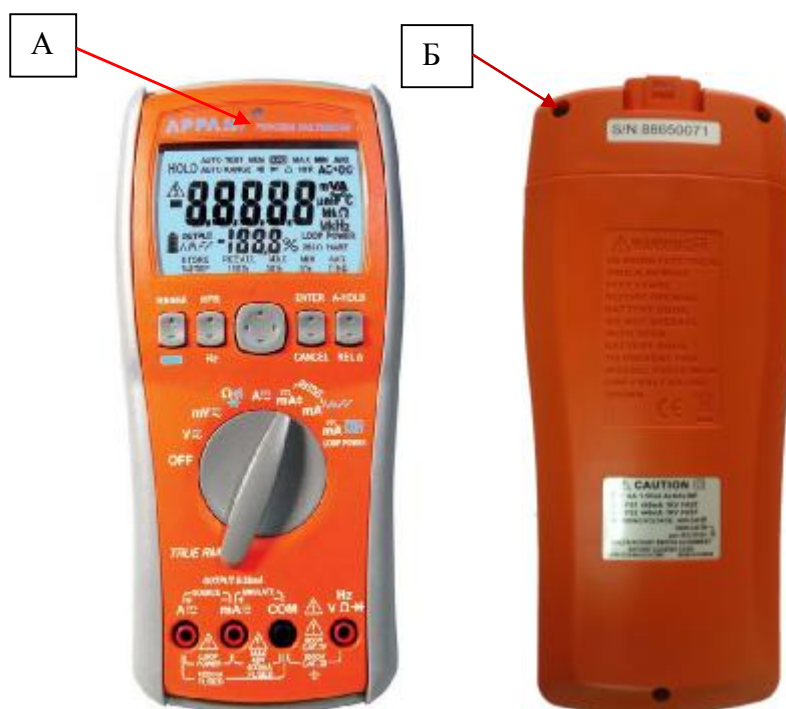
Рисунок 1 – Общий вид мультиметров, схема нанесения знака утверждения типа (А) и схема пломбировки от несанкционированного доступа (Б)
