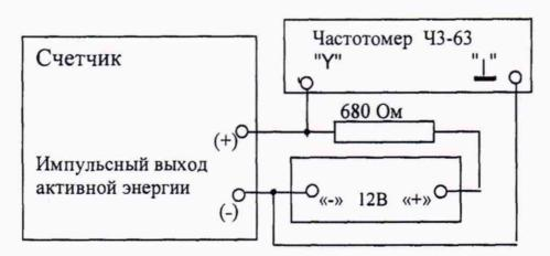
Рисунок А.2 - Схема проверки погрешности хода внутренних часов
