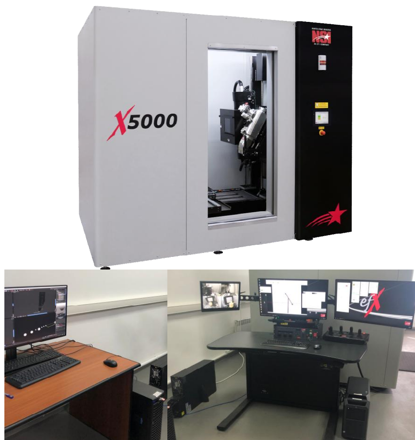
Рисунок 1 - Общий вид системы томографической X-VIEW X5000
