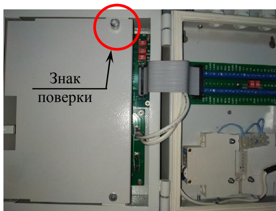
Рисунок 7 – Схема пломбировки СОИ
