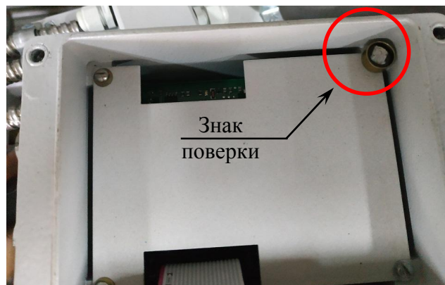
Рисунок 8 – Схема пломбировки ПРЭ
