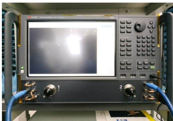
Рисунок 7 – Общий вид передней панели ВАЦ и передней панели блока управления сканером с указанием места размещения знака утверждения типа
