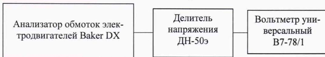
б) схема подключения для определения погрешности воспроизведений напряжения постоянного тока свыше 1000 В
