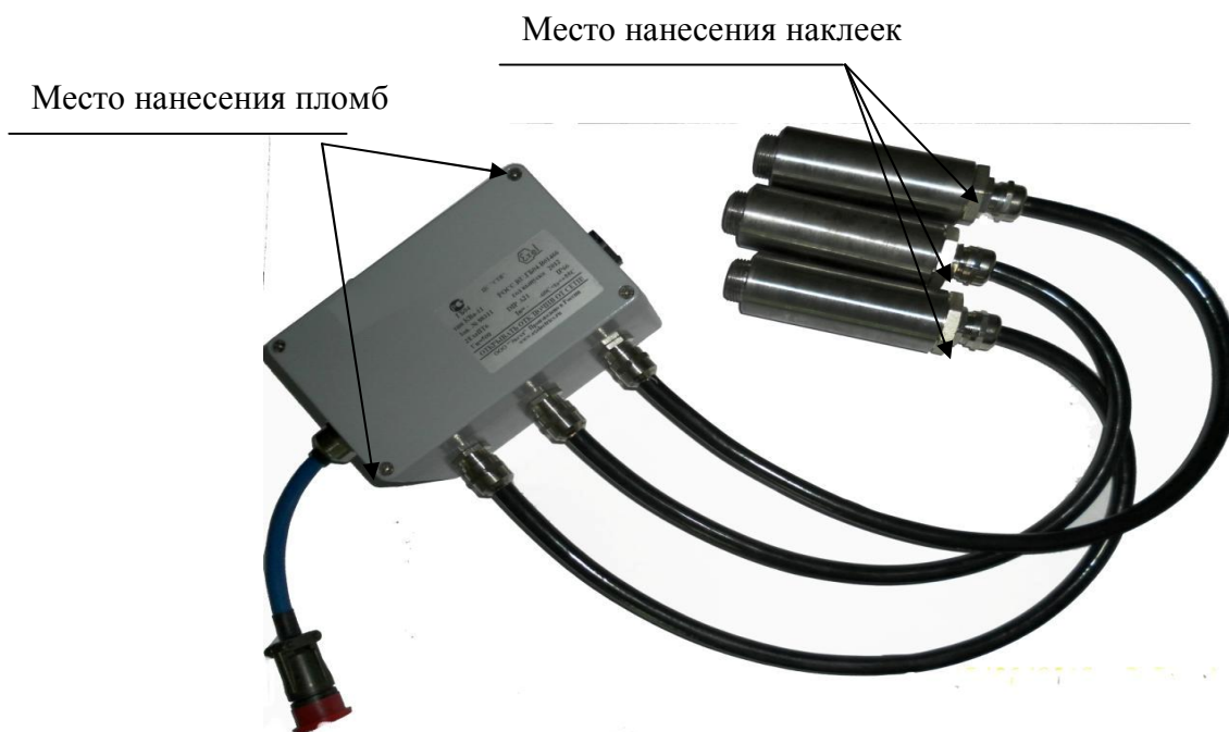
Рисунок 3 – Схема пломбировки регистраторов нормирующих горючих газов РГГ модификации РГГ-2 от несанкционированного доступа
