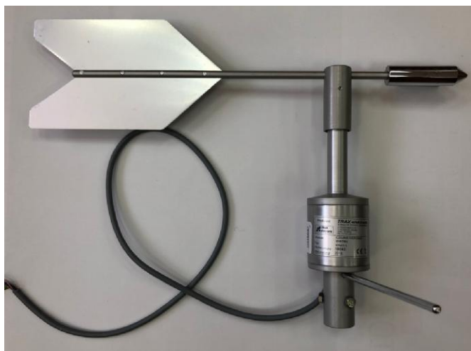
Датчик направления ветра KRW1.1
