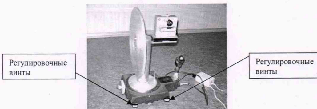
Рисунок 1 – Установка угломерная на основе столов поворотных СТ-9
