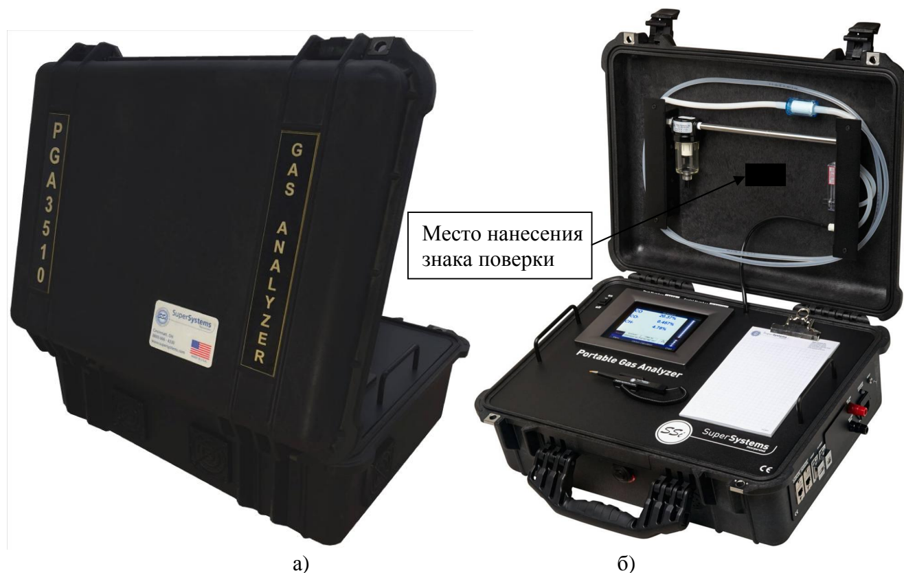
Рисунок 1 - Общий вид газоанализаторов с местом нанесения знака поверки
