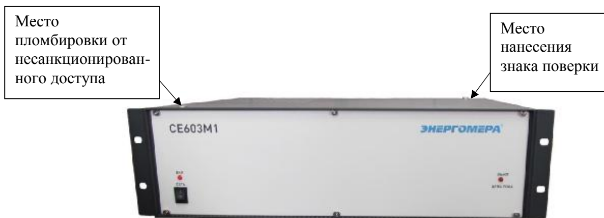
Рисунок 1 - Общий вид ваттметров-счетчиков исполнений CE603M1.1-XX-X-X, CE603M1.2-XX-X-X, схема пломбировки от несанкционированного доступа и обозначение места нанесения знака поверки
