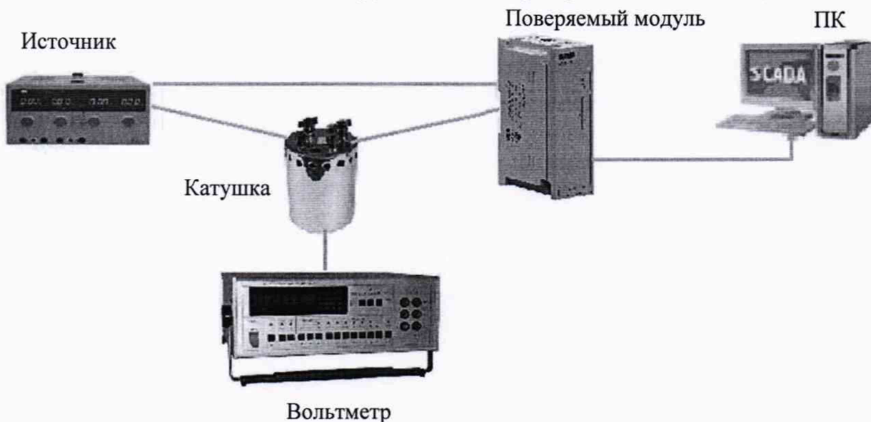
Рисунок 7 – Схема определения основной приведенной (к диапазону измерений) погрешности измерений (преобразований) при измерении входных сигналов от датчиков с унифицированным сигналом силы постоянного тока (при определении погрешности методом падения напряжения на сопротивлении)
