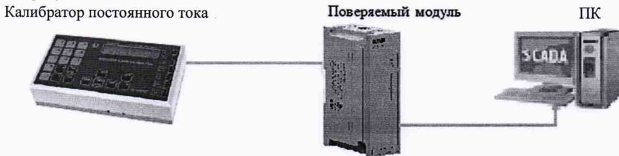
Рисунок 6 – Схема определения основной приведенной (к диапазону измерений) погрешности измерений (преобразований) при измерении входных сигналов от датчиков с унифицированным сигналом силы постоянного тока (при использовании в качестве эталонного оборудования калибратора постоянного тока)
